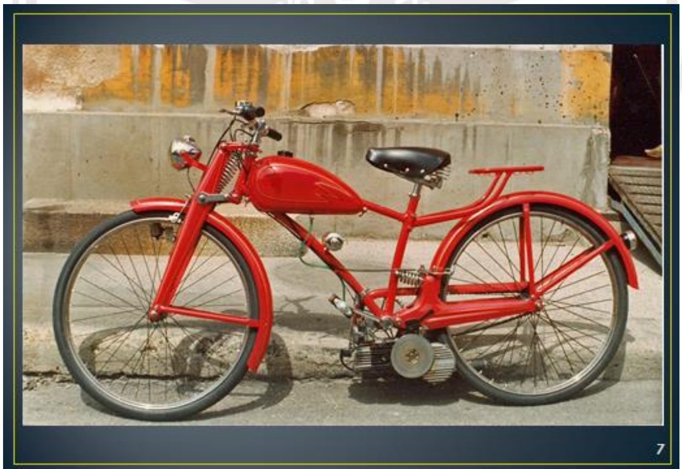
Dei primi ciclomotori con telaio in lamiera stampata
