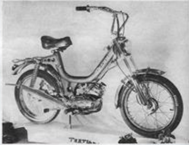
Il TESTI «Cricket» con motore Minarelli a 3 marce e raffreddamento forzato, con eccellenti sospensioni telescopiche.
