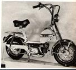
Il TESTI «Cricket» con motore Minarelli a 3 marce e raffreddamento forzato, con eccellenti sospensioni telescopiche.
