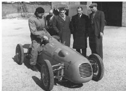
La Giaur 500 costruita nel 1950 da Bernardo Taraschi per la F3. Motore quattro cilindri Gianni 36 CV.
