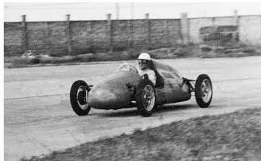
La Volpini con motore Gilera Saturno 500 riprende l'architettura delle Cooper 500 inglesi.
