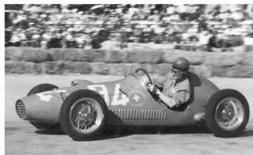
La Giaur (Giannini-Urania) Red Blitz per la categoria 750 Corsa, 1954. Peso totale 300 kg, motore Giannini G1, poi G2 bialbero 70 CV.
