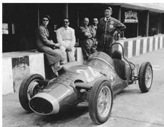
La Giaur Red Blitz di Luciano Gramagna, costruita da Berardo Taraschi con motore, all'origine, Giannini G1, montava a Monza un motore Fiat 1100 preparato da Volpini.
